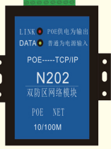
N201/ N202 防区网络模块 与H778S+和EH608系列配套使用也可单独配软件，组成总线和网络一体化报警平台宽电压输入电压9V---24V，静态电流低100毫安左右；纯网络传输无延时，全隔离稳定可靠；采用进口防雷通讯保护电路。抗雷击和脉冲干扰强。 可接入1或2个常闭NC或NO或带电阻防区； 可选配POE(802.3af标准)供电（12v 30W） 简化布线、节省人工成本,安全方便
