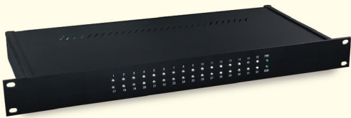
32路网络联动模块 标准化1U 机型的联动矩阵功能说明；标准化 1U 机箱封装，外形美观适宜化机柜安装；面板带32颗指示灯提醒防区状态；电压指示及工作指示灯提醒；硬件一键复位功能；拨号方式设置机器地址，最多15台480个防区（可扩展更多）；设备集成网络、485总线、CAN总线方便用户组网和系统集成。
